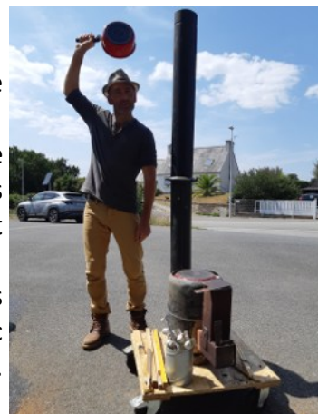
Fabrication d'un poêle à bois artisanal, dit « Rocket stove »
